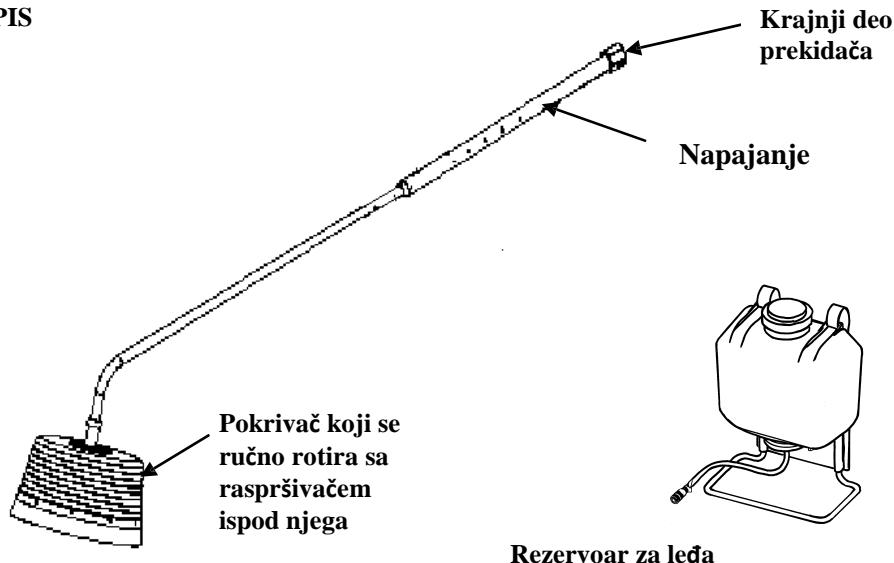
HERBIDOME 350 je ručni raspršivač sa pokrivačem, diskom koji se rotira i kontrolisanom primenom kapljice (CDA). HERBIDOME 350 se napaja pomoću četiri baterije tipa za bater lampu (D-ćelija/R20), a jedan komplet baterija dobrog kvaliteta daje oko 40 sati prskanja. Konstruisan je za primenu herbicida, u okviru ručno rotirajućeg pokrivača prečnika 35cm, u zapreminama od oko 50 litara/hektar.
