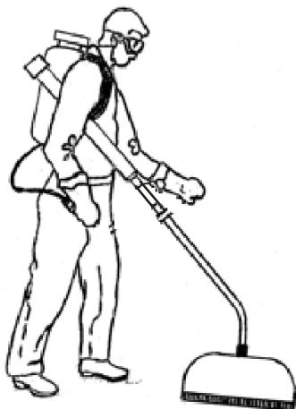
Počnite da hodate. Tečnost za prskanje se emituje. Kada prskate, glava za prskanje treba da se drži što je bliže moguće zemlji ili vrhu kupole za korov sa pokrivačem pod uglom od oko 5 stepeni prema horizontali. Vodeća ivica ruba montirana na pokrivač treba da dodiruje zemlju ili vrh kupole za korov. Videće se kako pokrivač rotira. **Važno je rotirati pokrivač što je moguće više da bi ugrađeni čistač korova dejstvovao.**
