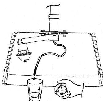
Stvarnu brzinu protoka treba proveriti držeći HERBIDOME 350 u poziciji za prskanje (pogledajte 'POČETAK PRSKANJA'). Skinite mlaznicu za napajanje sa raspršivača i pustite da tečnost poteče u odgovarajuću posudu.
