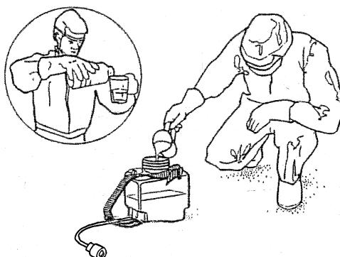
Do pola napunite rezervoar za leđa čistom vodom i proverite da li negde curi.
